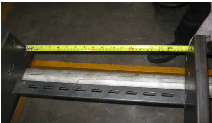
Cek lebar benda uji
